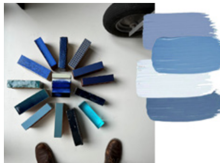
Voor de plint en het dakterras worden restpartijen blauw geglazuurde tegels of steenstrippen gebruikt.
